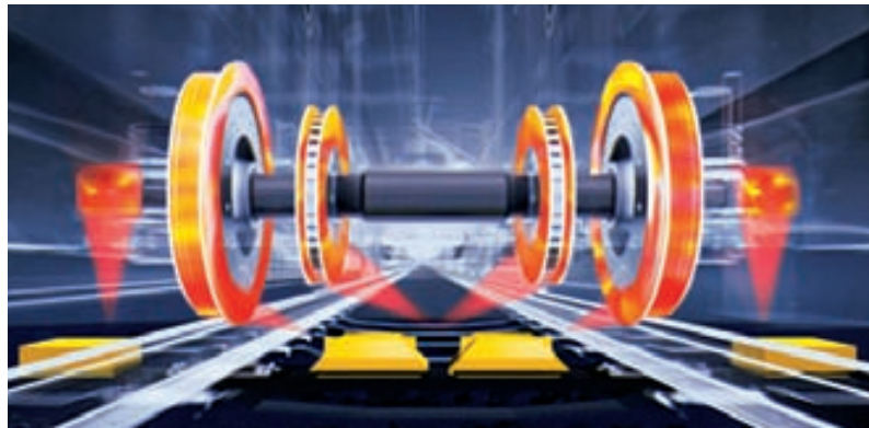
Bildsimulation mit allen möglichen Bereichen der Temperaturüberwachung: Achslager, Radreifen und Bremsscheiben.
