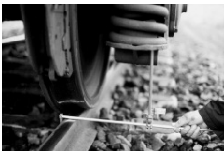
Bild 4a: Achslager mit Untertzug des Y25 Drehgestells
